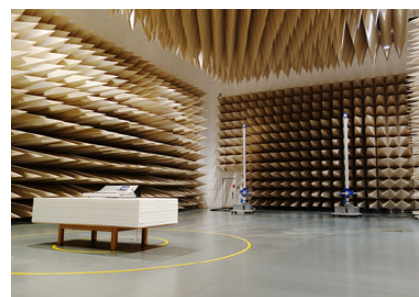
電磁波測定に使用する電波暗室
