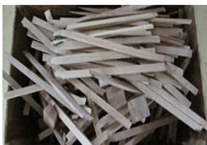
従来は廃棄していた端材を隅木(ギターボディ内部の補強材)に転用
