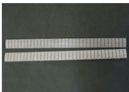
従来は廃棄していた端材を隅木(ギターボディ内部の補強材)に転用
