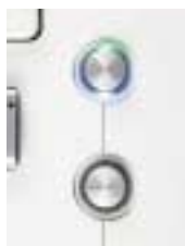
ピックアップセレクターはLEDでピックアップの選択状態を表示。
