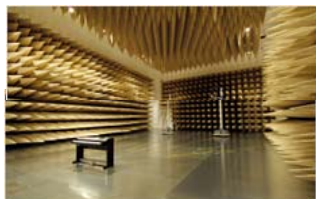
電磁波測定に使用する電波暗室
