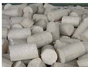
ピアノ製造工程から排出された木粉をペレット化してつくられた「木粉ブリケット」
