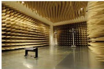
電磁波測定に使用する電波暗室
