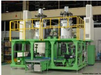
自動車のガソリタンクやカーエアコンの密封性を短時間で正確に測定し、燃料や冷媒などの微細な漏れを防ぐことで、自動車の環境規制対応や運転時の環境負荷低減に役立っています。
