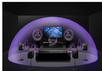
バーチャルハイトスピーカーを使用した 7.2チャンネル再生（RX500A）
