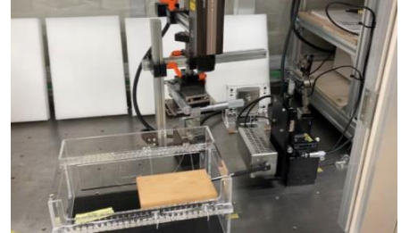
タッピング法による振動試験
