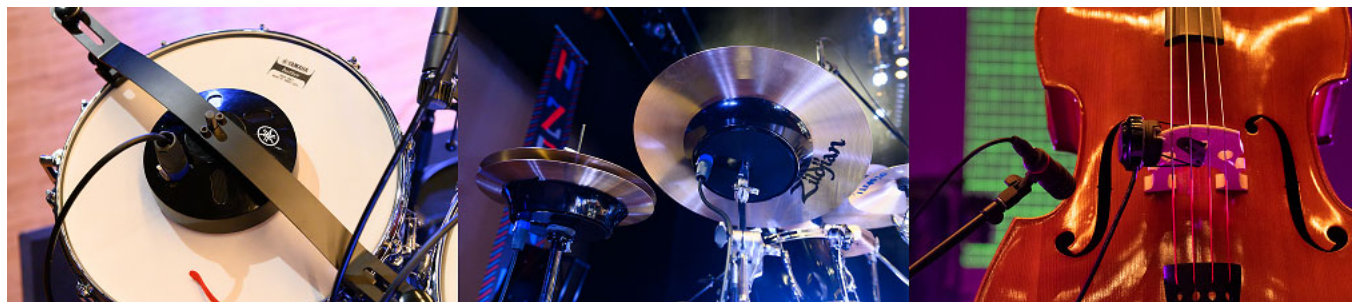
電気信号を振動に変換して楽器の自動演奏を可能にする装置
