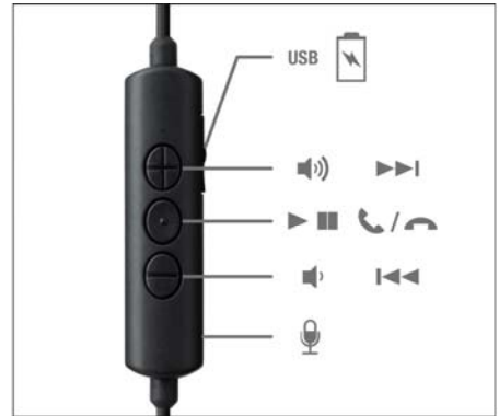
通話操作や音声コントロール機能にも対応したリモコン
