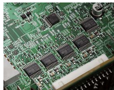
2chステレオ仕様のバーブラウン384kHz/32bit*1 D/Aコンバーター(写真はRX-V583のものです。)
