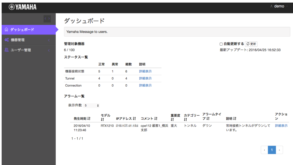
図 5: ダッシュボード表示例 複数機器の異常を一画面で表示
