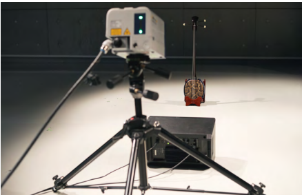
レーザードップラー振動計による計測
