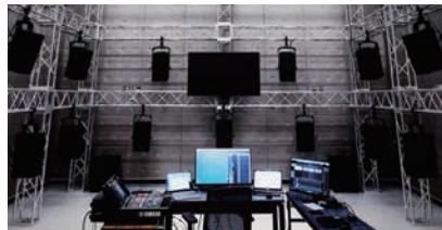
マルチスピーカーによるSound xR Image再生システム
