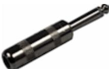
**TS** es la abreviatura de “manguito de punta” (Tip-Sleeve) y se refiere a un tipo específico de conector de 1/4”, configurado para una operación desequilibrada de dos conductores. En general, la punta se considera “activa” (energizada) o el lugar donde se aplica la señal, mientras que el manguito es donde se conecta la tierra o el blindaje.
