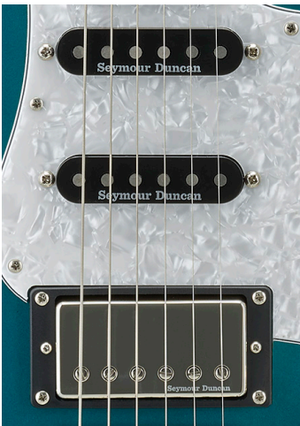
Dos pastilla de bobina únicas (arriba) y pastilla humbucker.
