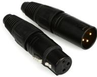
El **XLR** (retorno de línea externo [External Line Return]) es un conector circular de 3 clavijas: positiva, negativa y de tierra. Estos conectores se utilizan normalmente para transmitir señales equilibradas a nivel del micrófono hacia los mezcladores, o señales a nivel de línea hacia altavoces alimentados.
