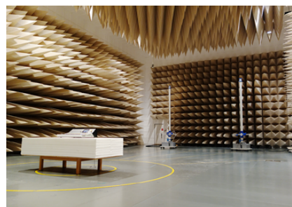
電磁波測定に使用する電波暗室
