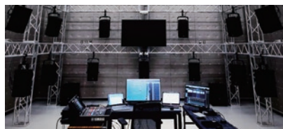
マルチスピーカーによるAFC Image再生システム
