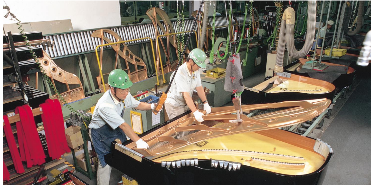
グランドピアノの組み立て工程
