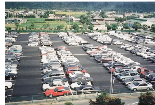
鋳物廃砂やスラグをアスファルトに利用した豊岡工場駐車場
