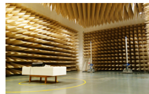
電磁波測定に使用する電波暗室
