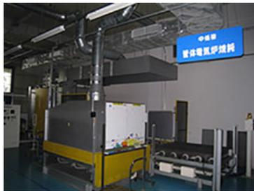
更新した電気焼鈍炉
