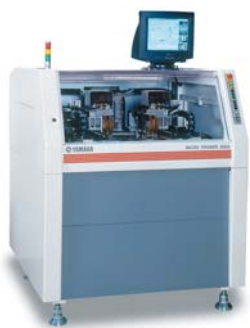
導通絶縁検査機マイクロプローバー M504
