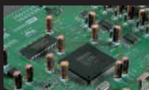
Sound signal processor LSI chip for AV amplifiers
