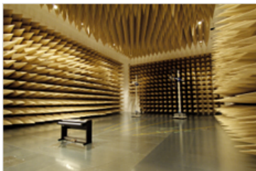
電磁波測定に使用する電波暗室
