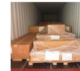
標準化前の梱包箱のコンテナ(左)と積載状況標準梱包箱のコンテナ積載状況(右)
