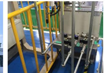
循環水で供給可能な冷却装置
