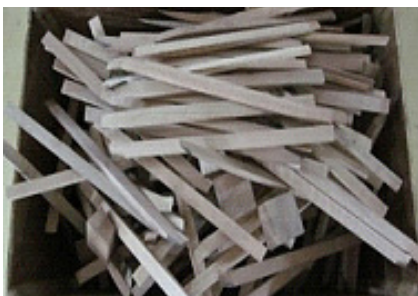
従来は廃棄していた端材を隅木(ギターボディ内部の補強材)として再利用
