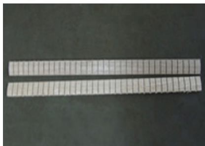
従来は廃棄していた端材を隅木(ギターボディ内部の補強材)として再利用
