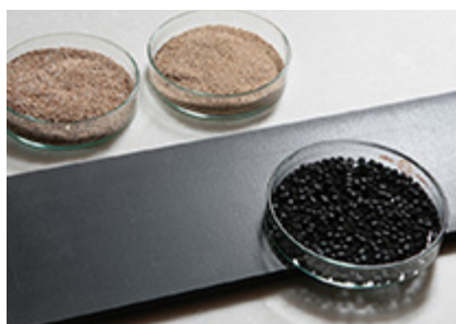
WPC(Wood Plastic Composite)の原材料として再利用
