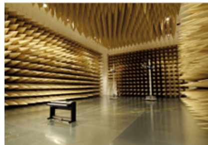
電磁波測定に使用する電波暗室
