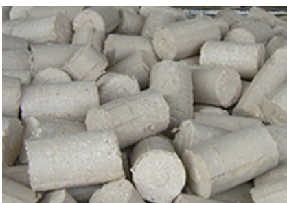
ピアノ製造工程から排出された木粉(ペレット化)
