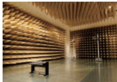
電磁波測定に使用する電波暗室
